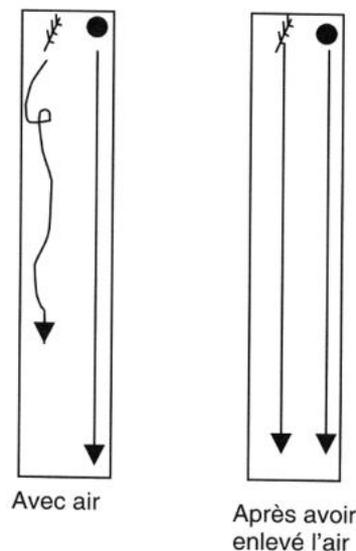
Au laboratoire, nous pouvons enlever une bonne partie de l'air d'un tube en l'aspirant avec une pompe à vide (mais on ne peut faire un vide parfait). Dans ce tube (appelé tube de Newton) sont enfermés un morceau de plomb et un morceau de plume.
