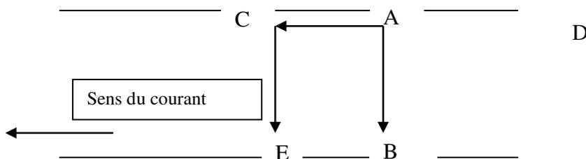
S'il n'y a pas de courant, il parcourt la distance AB de 100m en une minute en MRU. Supposons que le courant soit aussi de 100m par minute. Si le pêcheur coupe son moteur, de A il se dirigerait vers C en MRU à la vitesse du courant.
